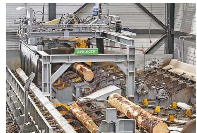
Mit einer zusätzlichen, oben liegenden Fräswelle können zu dicke Stämme auf 800 mm Durchmesser abgefräst werden
