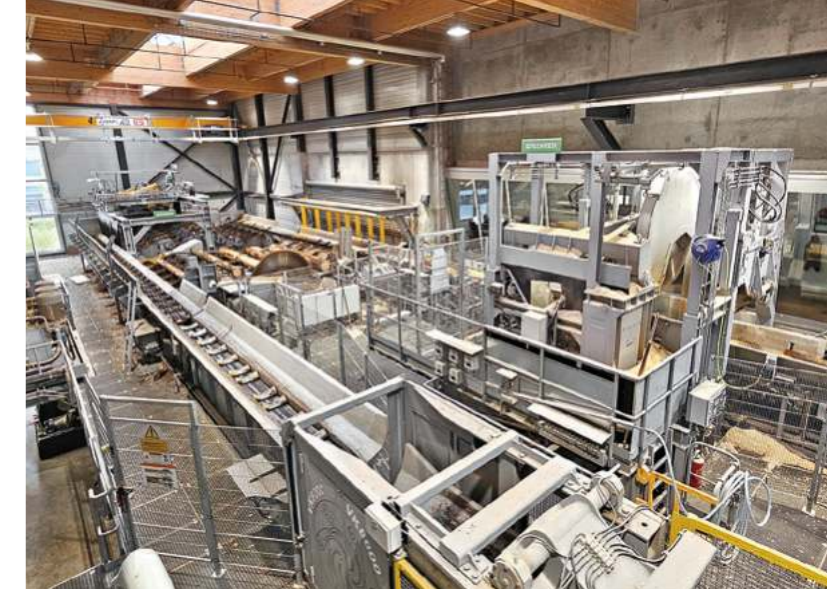
Vor der Entrindung werden die Stirnseiten gekappt und die Wurzelansätze reduziert
