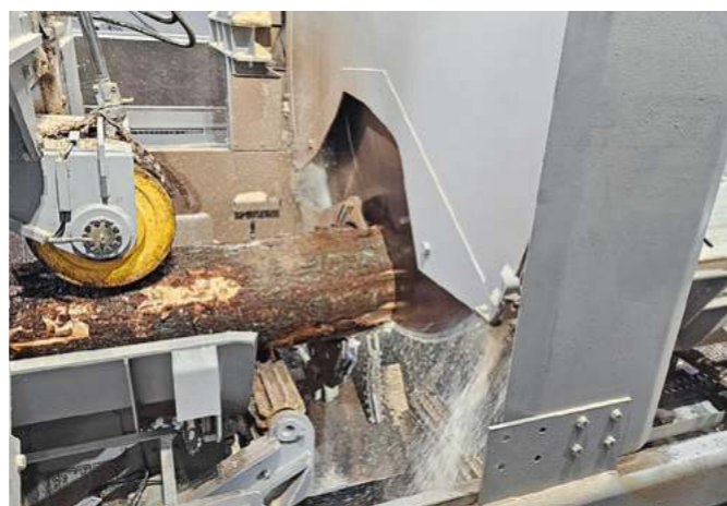
Von den Aufgabedecks gelangen die Bloche im Längstransport zu einer Kappsäge, wo sie abgelängt werden
