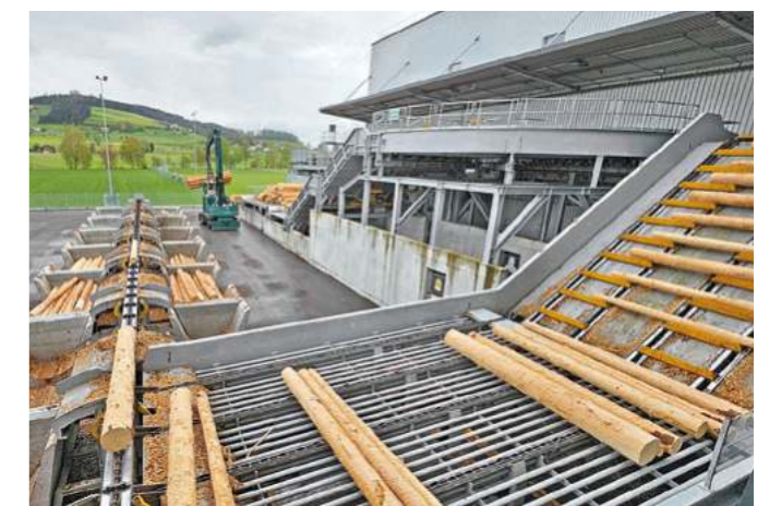
Während einige Stämme in Boxen sortiert werden, gelangt ein wesentlicher Teil des Holzes über einen Stufenförderer (re.) direkt und unsortiert ins Sägewerk
