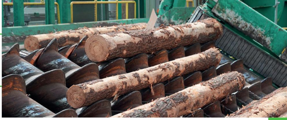
Die innovative Schraubentechnologie von SPRINGER transportiert die Stämme im Schraubsystem kettenlos weiter und überzeugt durch geringe Lärmentwicklung, optimale Wirtschaftlichkeit und hohe Geschwindigkeiten bei der Zubringung zu Rundholzsortieranlagen und Sägelinien.
