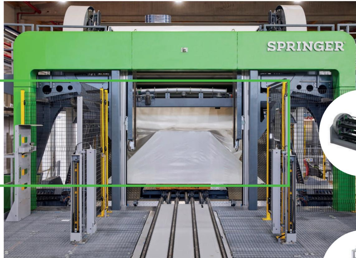
Das innovative Maschinenkonzept des ED 3000 Wrappers ermöglicht eine effiziente und automatische Folierung von Schnittholzpaketen in Hobelwerken und Schnittholzanlagen.
